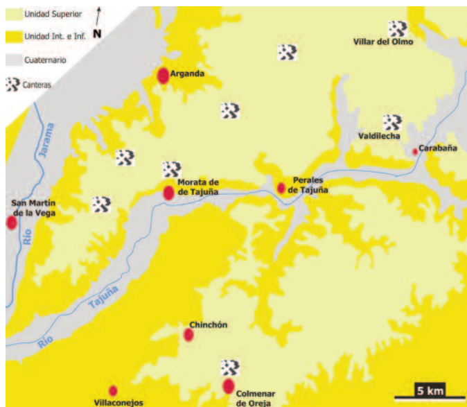
Figura 3. Mapa geológico simplificado de los páramos de Chinchón-Colmenar de Oreja y de Arganda-Morata de Tajuña y localización de las principales canteras donde los carbonatos fluvio-lacustres de la Unidad Superior Miocena son y/o han sido explotados (a partir de García del Cura et al. , 1999).
