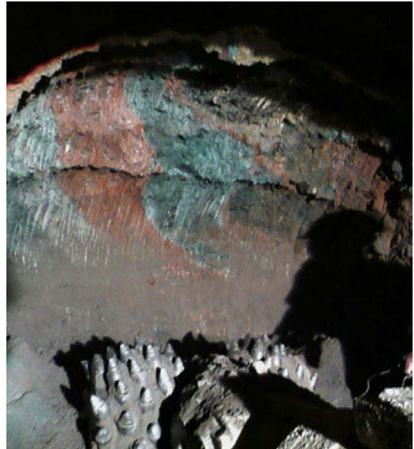
Figura 19. "Duplex" de arcilla roja y roca volcánica en el frente de la nueva galería (SYSMIN).
