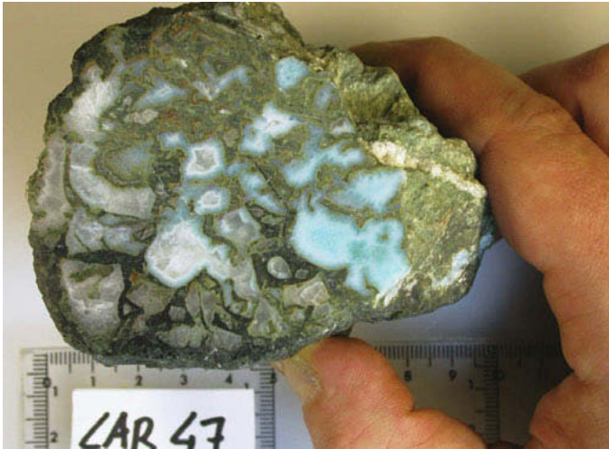
Figura 32. La sección del tallo muestra la pectolita transparente que sustituyó totalmente a la pectolita negra carbonosa y, después, se sustituye por la azulada, al menos parcialmente. La calcita ocupa el centro de esta última sustitución.
