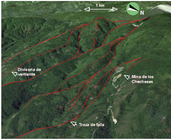
Figura 12. La falla del río Cito, aunque de carácter de cizalla sinistral, forma parte de un apilamiento general de escamas tectónicas de gran magnitud. Figure 12. Cito fault, although of a sinistral nature, forms part of a thrust-slice stacking associated to the Cito River.
