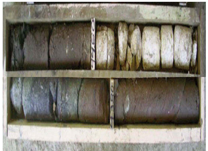
Figura 17. Tránsito desde la serie volcánica a las calizas de la Formación Polo al sur del yacimiento de Larimar. Sondeo SL3.
