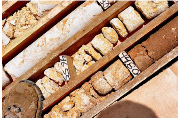
Figura 16. Paso a las calizas de la formación Polo desde la serie volcánica productiva en el sondeo SL 1.
