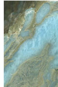
Figura 18. Otro ejemplo que muestra la escasa dimensión de las fibras cuando la pectolita se estaba deformando. Figure 18. Another example showing small fibers when the pectolite was deforming.
