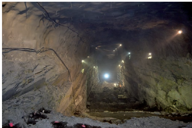
Figura 2. Cámara de explotación de una mina subterránea de pizarra activa (fuente: propia gracias a la colaboración de Pizarras Gallegas, S.A.).
