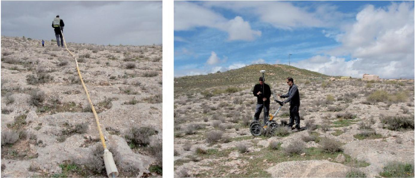
**Figura 4.** Realizando medidas de GPR con antena de 25 MHz (foto de la izquierda) y antena de 250 MHz (foto de la derecha).
