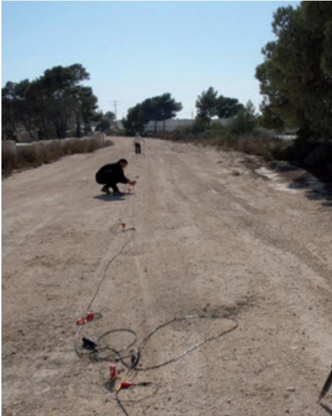
**Figura 8.** Toma de medidas de sísmica de refracción.
