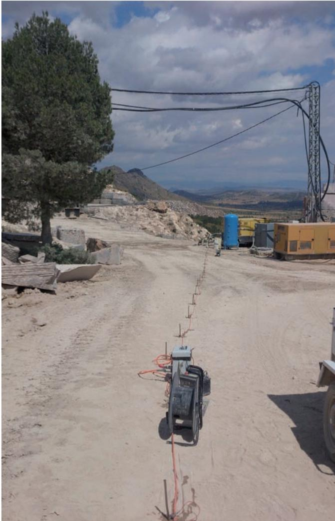
**Figura 5.** Toma de medidas con tomografía eléctrica.
