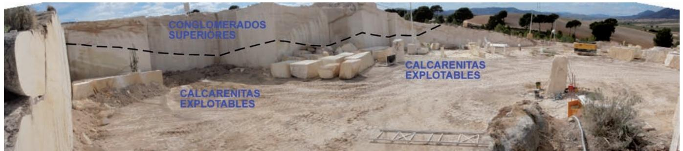
Figura 17. Imagen de la cantera con disposición de los materiales.
