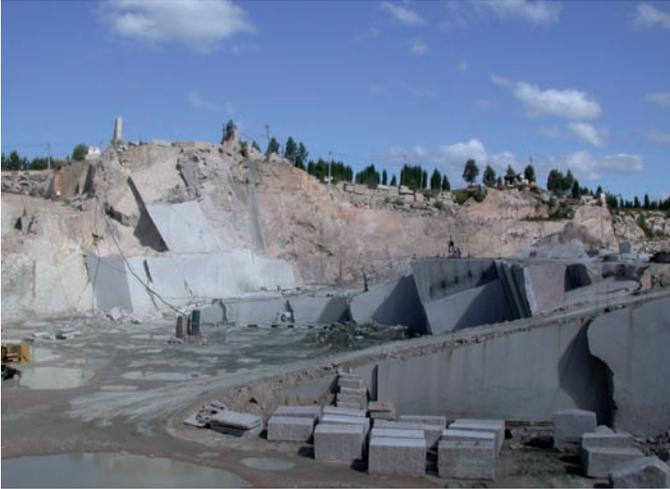
**Figura 5.** Fracturación con espaciado amplio y corte con hilo. Nótese el corte con talud invertido, condicionado por el “andar”.
