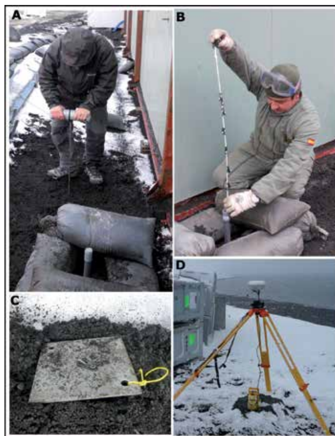
Figura 4. (A) Sondeos mecánicos manuales para la media del espesor de la capa activa; (B) Sondeo térmico que contiene una cadena de registradores miniaturizados de temperatura; (C) Placas isotermas de 20x20 cm para la media de la temperatura bajo la base y en su interior; (D) Antena de GPS diferencial empleada para el levantamiento topográfico.
