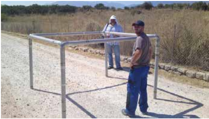
Figure 10. (a) 2 x 2 m single loop 1.30 m above the ground; (b) the same loop, 0.14 m above the ground. Figura 10. (a) Bucle sencillo 2 x 2 m y 1.30 m sobre el terreno; (b) el mismo bucle pero 0.14 m sobre el terreno.
