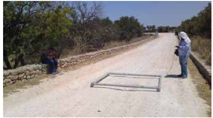
Figure 10. (a) 2 x 2 m single loop 1.30 m above the ground; (b) the same loop, 0.14 m above the ground. Figura 10. (a) Bucle sencillo 2 x 2 m y 1.30 m sobre el terreno; (b) el mismo bucle pero 0.14 m sobre el terreno.
