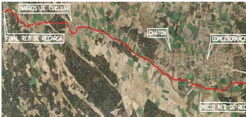
Fotografía 6. Trazado en planta de la red principal de arroyos para la recarga del sector occidental del acuífero de los Arenales en la comarca de El Carracillo. Photograph 6 Layout of the main recharging streams in the western sector of the Arenales aquifer in the region of El Carracillo.
