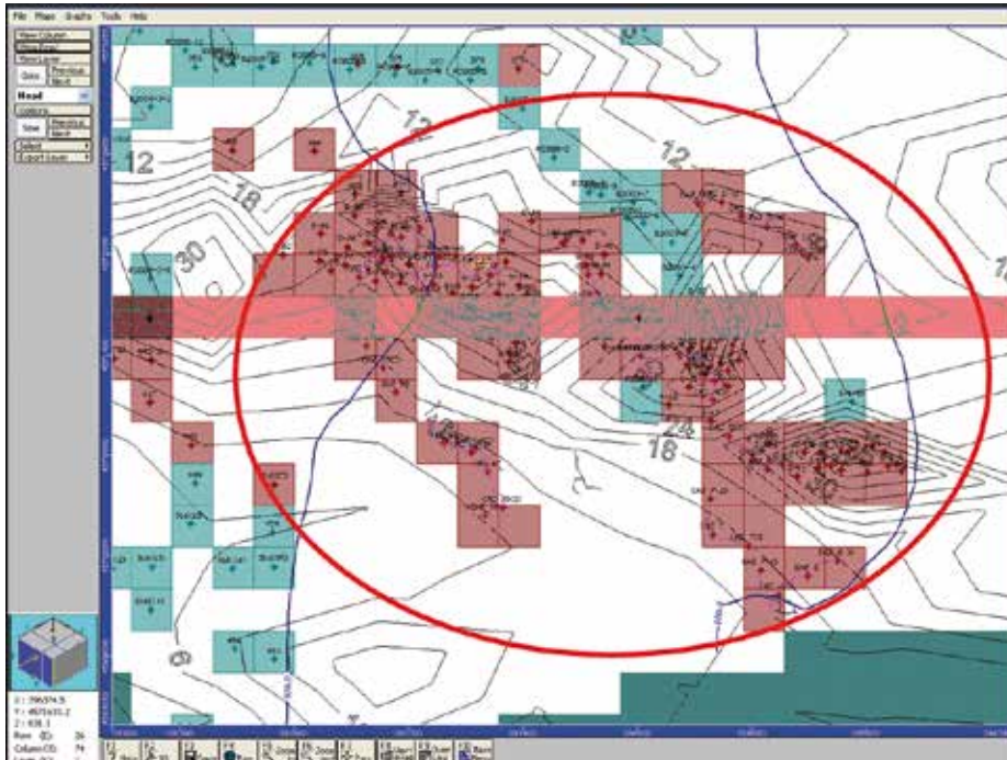
Figura 10. Salida gráfica de Visual MODFLOW en la que se muestra la planta de la denominada “zona almacén” del acuífero sobre el mapa de isopacas. La fila 26 está marcada en rojo. Las celdas de color rojo dentro del círculo indican la ubicación de los dispositivos de recarga y la batería de pozos de extracción.
