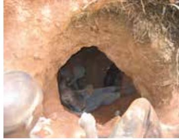
**Figura 18.** Cuatro mineros artesanales trabajando en condiciones inseguras, sin equipamiento protector ni elementos de consolidación de los huecos.
