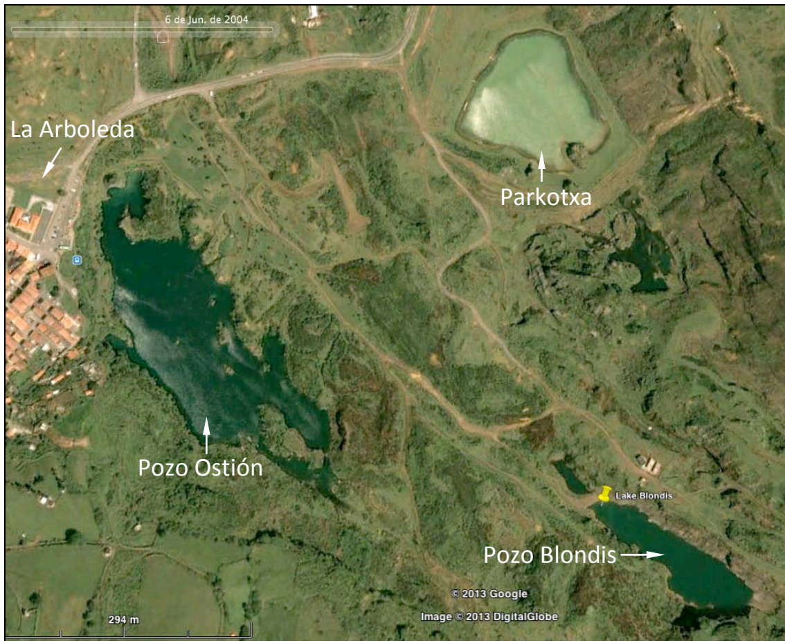
Figura S6. Imagen de satélite de la zona de La Arboleda tomada de Google Earth, correspondiente a junio de 2004, donde se observan los lagos formados en las antiguas explotaciones, así como la barra de rellenos que atraviesa el pozo Blondis en su extremo NW, y que en aquella época dividía el lago y conformaba un mini-cubeta.
