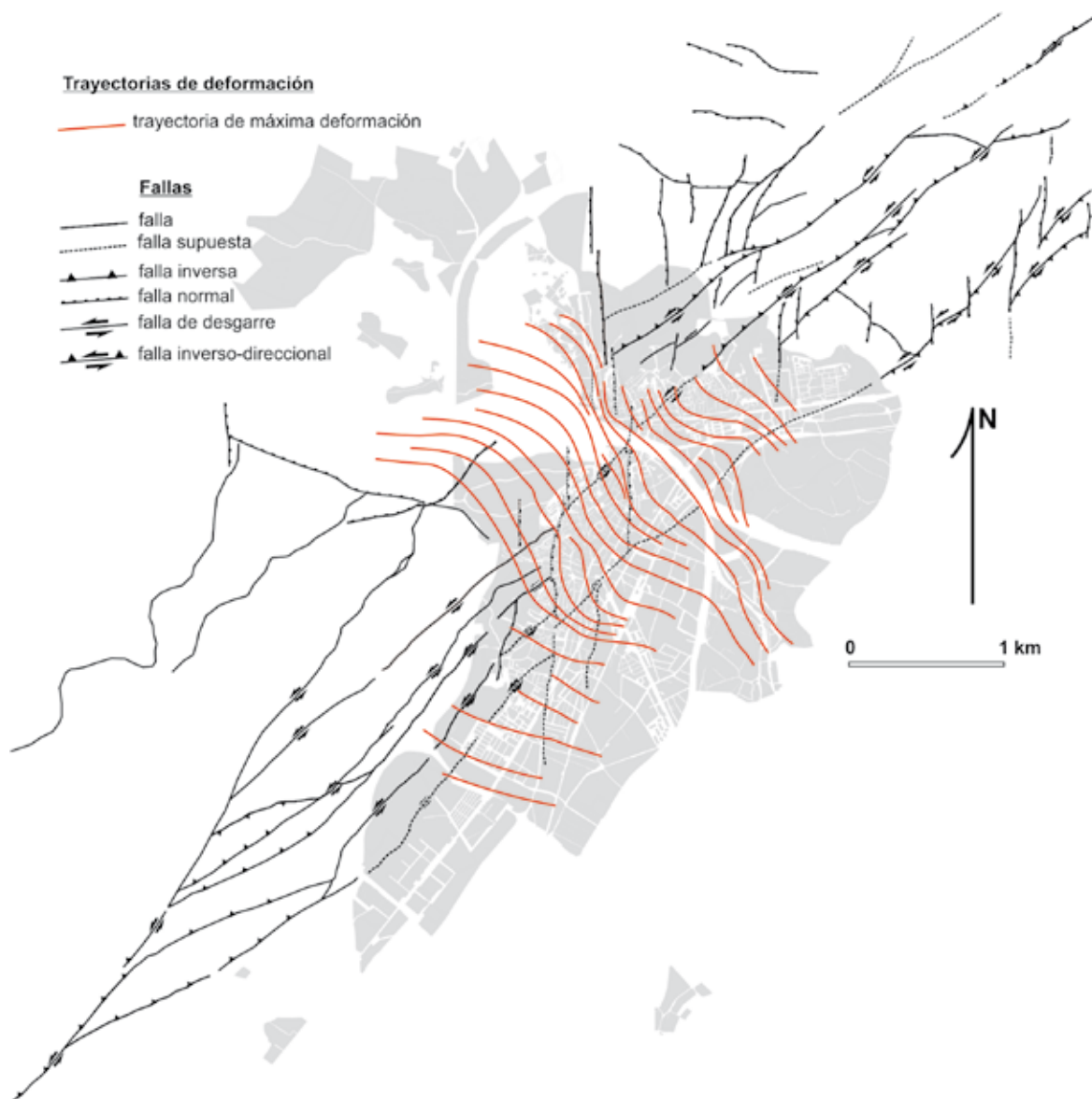
Figura 6. Trayectorias de máxima deformación construidas a partir de la interpolación de los resultados puntuales de máxima deformación deducidos del análisis individual de las estructuras (EAE's). Se representan también las principales estructuras tectónicas presentes en la cartografía geológica a escala 1:25.000.
