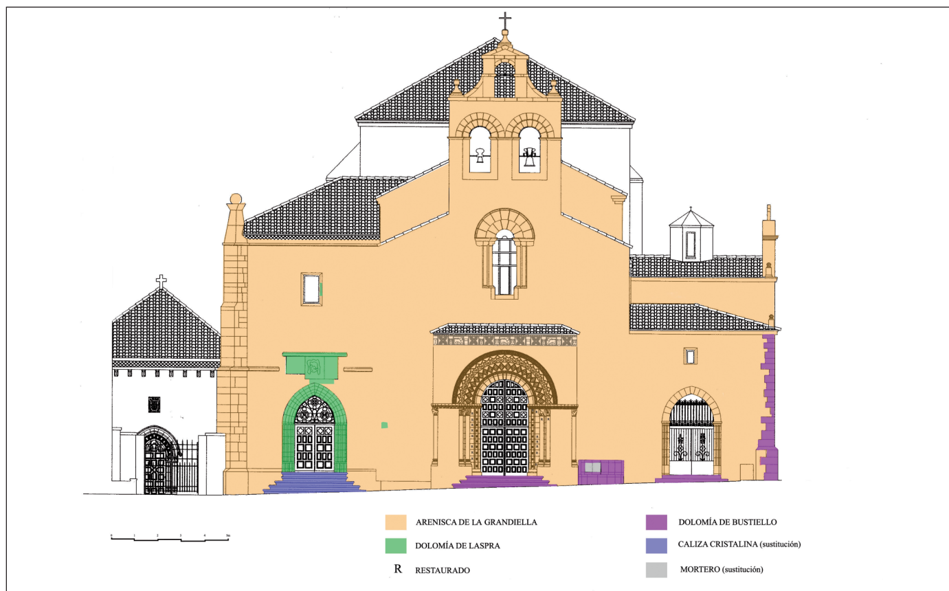
Figura 4. Cartografía litológica sobre el alzado de la fachada Figure 4. Lithological map projected onto the elevation of the façade
