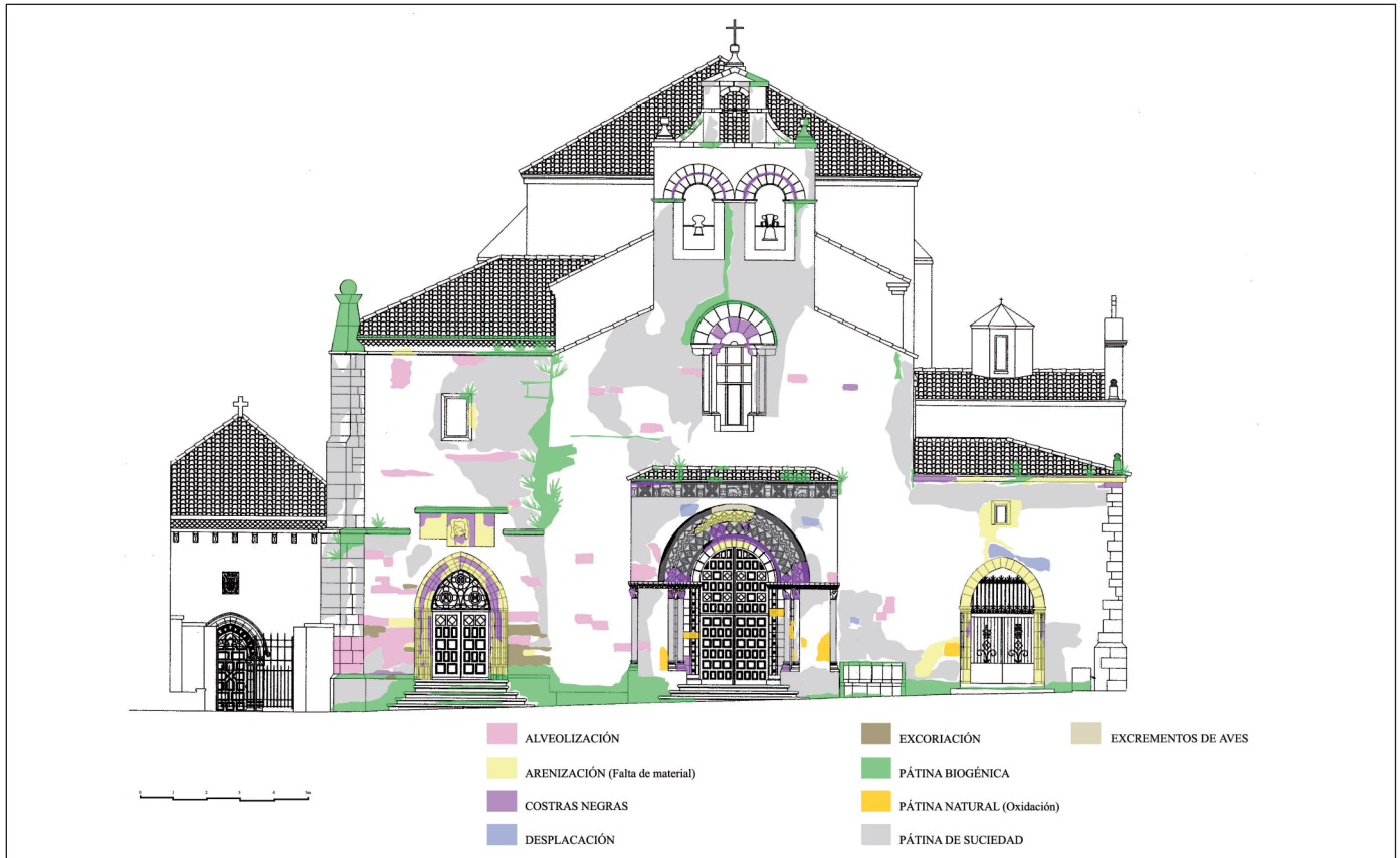
Figura 10. Cartografía de lesiones sobre el alzado de la fachada Figure 10. Damage map projected onto the elevation of the façade
