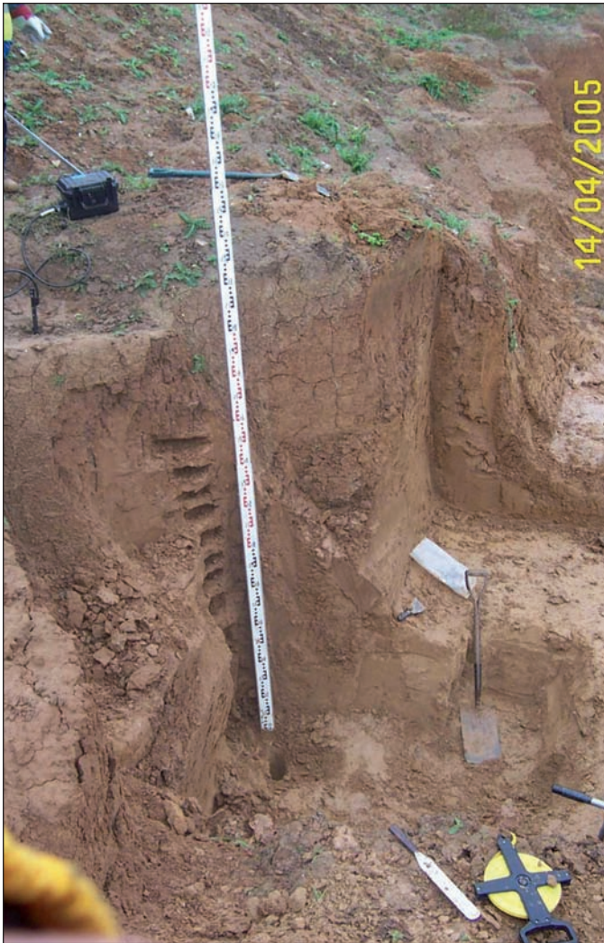
Foto 1. Perfil del suelo en calicata Pit 3 Photo 1. Soil profile in exploratory Pit 3
