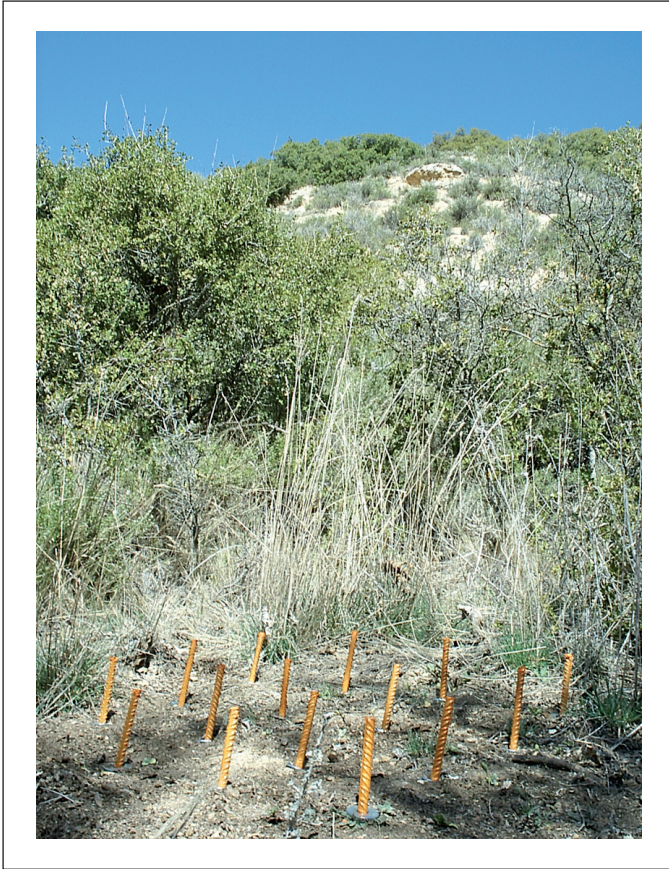
Figura 5. Parcela de muestreo de la sedimentación tras una importante rotura de pendiente en materiales Cretácicos Figure 5. Sedimentation sampling plot after a slope break in Cretaceous materials
