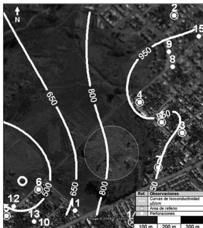
Figura 9. Isoconductividad eléctrica en agua subterránea en área de relleno en noviembre de 2008
