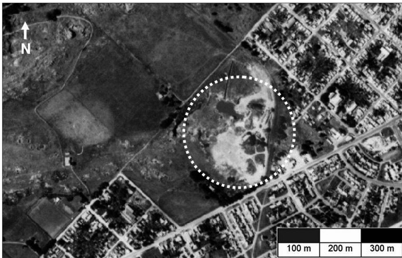
Figura 2. Fotografía aérea de cava rellena con residuos de industrias de fundición (año 1980) Figure 2. Aerial photograph of quarry filled with foundry industry waste (year 1980)
