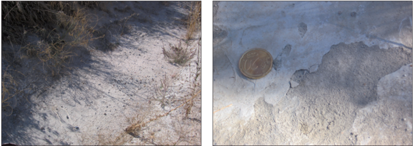
Figuras 4 a) y b). Precipitados de carbonato en el fondo del canal "oeste" (punto IN-11) Figures 4 a) y b). Carbonate precipitation in the bottom of the artificial recharge West channel (IN-11 testing point)
