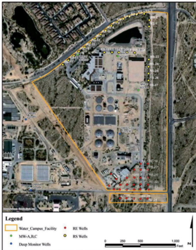
Figure 3. The city of Scottsdale Water Campus facility. A water reclamation and potable water treatment plant performing aquifer storage using vadose zone recharge wells and ASR wells Figura 3. La instalación del Campus del Agua en la ciudad de Scottsdale. Es una planta depuradora y potabilizadora que posibilita el almacenamiento en el acuífero mediante pozos de recarga en la zona no saturada y pozos ASR
