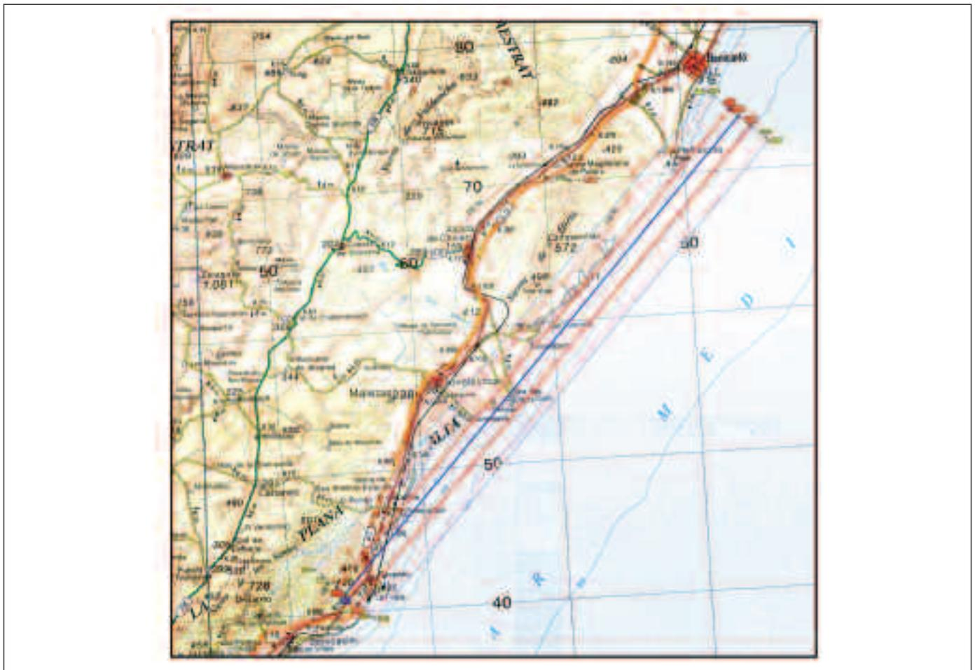
Figura 5. Esquema de los vuelos (21/06/2006). Centro de las pasadas bajas P1 y P2 en rojo. Centro de la pasada alta P3 en azul
