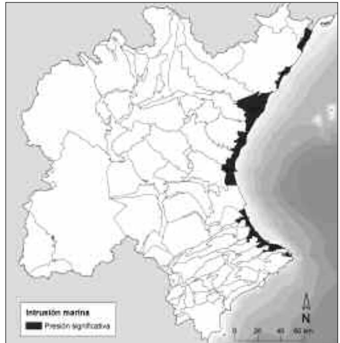
Figura 6: Presión significativa en las masas de agua subterránea costeras conforme al índice de densidad de captaciones subterráneas
