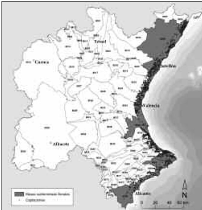
Figura 5: Captaciones de agua subterránea en una franja de 10 kilómetros de anchura desde la línea de costa hacia el interior de las masas de agua subterránea costeras
