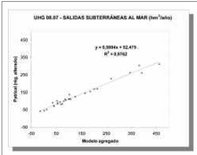
Figura 10: Correlación entre el volumen de salida al mar obtenido por el modelo agregado y el modelo Patrical en la masa 080.008 Maestrazgo Oriental
