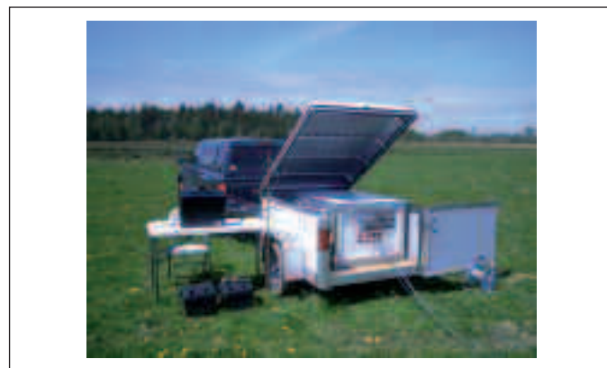
Fig 7. GeoMRI, 4-channel MRS instrument (April 2006) Fig. 7. Instrumento SRM GeoMRI de 4 canales (Abril 2006)
