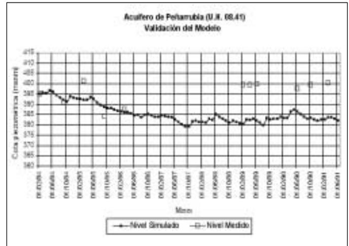
Fig. 3. Validación del modelo con el valor de los parámetros de  $M$ ,  $N$  y  $S$  que proporcionan un mejor ajuste en la etapa de calibración
