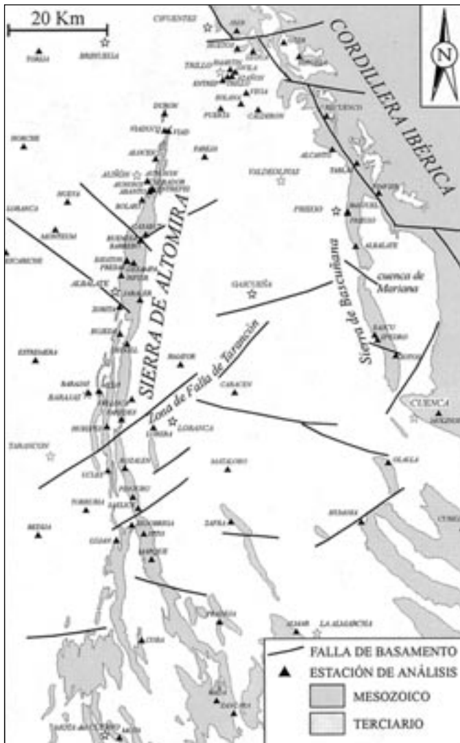
Fig. 2. Mapa de posición de las estaciones de análisis estructural frágil, y principales fallas de basamento deducidas a partir de los datos geofísicos publicados por Querol, 1989; Perucha et al., 1995 y Muñoz Martín y De Vicente, 1998
