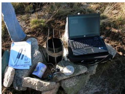
Descarga de información pluviométrica
