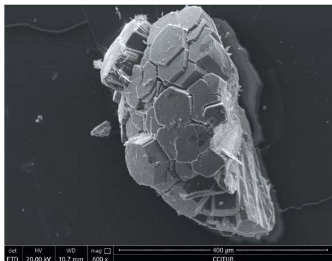
Figura 31. Imagen SEM de un agregado compacto de cristales de erionita-K. Colección y foto: Adolf Cortel.
