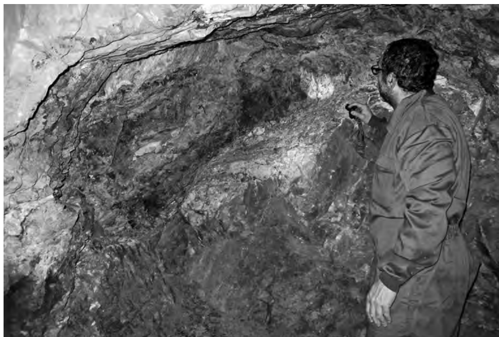
Figura 18. En el interior se reconocen pequeños lentes y enclaves de granitoides algo pegmatoides y masas verdosas de minerales de skarn con condrodita, flogopita y serpentina, con las que parece estar relacionada la mena principal
