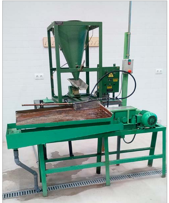
Fig. 36. Mesa Wilfley más moderna que las utilizadas a comienzos del siglo XX, aunque apenas han modificado sus fundamentos principales. Ésta en concreto perteneció a la SMMP (probablemente date de los años 40-50 del siglo XX) y procede de alguna de sus instalaciones de La Unión (Murcia), aunque actualmente se encuentra en los laboratorios de la Escuela Politécnica Superior de Linares. Foto: I. Ramos (febrero 2018).
