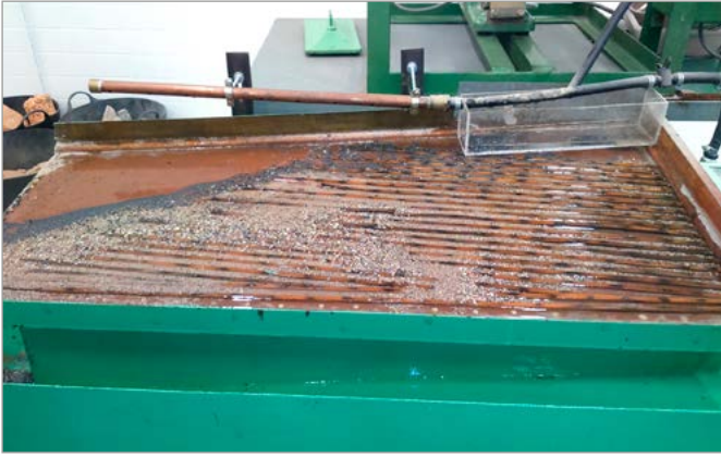
Fig. 37. Otra vista de la mesa Wilfley de la figura 36, esta vez en funcionamiento (precisa agua). Obsérvese cómo la galena (color gris), más pesada, se va separando del resto de fragmentos del mineral triturado y concentrándose en una franja de la mesa. Foto: I. Ramos (febrero 2018).
