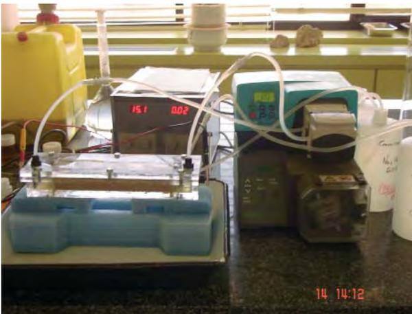
Instalación de laboratorio para el tratamiento por electrodiálisis de suelos contaminados.
