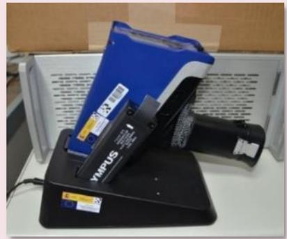
Imagen 18: Analizador FRX Vanta
