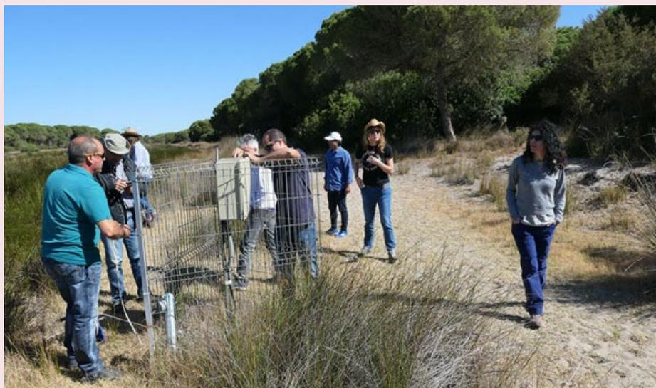
Imagen 9: Mantenimiento de infraestructura científica de un meteolisímetro de precisión del IGME en el Parque Nacional de Doñana para monitorizar el balance hídrico del suelo y su afección por el cambio climático. Claus Reimer Kohfahl, IGME.
