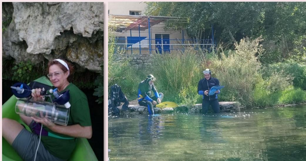
Imagen 17: Toma de muestras de los manantiales subacuáticos en las lagunas de Ruidera. Izquierda: botella muestreadora horizontal de cierre hermético que lanza el equipo de apoyo en superficie hacia las surgencias localizadas en el fondo de las lagunas. Derecha: preparación del equipo de inmersión que localiza las surgencias en el fondo de las lagunas. Pedro A. Robledo Ardila y Raquel Morales García, respectivamente, IGME.
