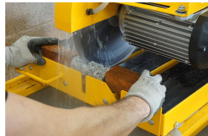
Corte de testigos en nave taller, litoteca. Autor: Carlos Camuñas Palencia, IGME-CSIC.
