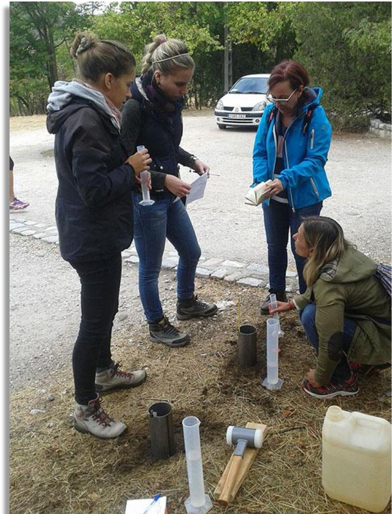
Imagen 8. Ensayos de infiltración con anillo simple (zona Universidad Complutense de Madrid).
