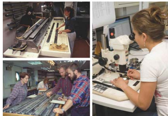
Descripción de las muestras de sedimentos, muestreos y análisis a bordo del Buque de perforación JOIDES Resolution. Fotos: Estefanía Llave Barranco y IODP
