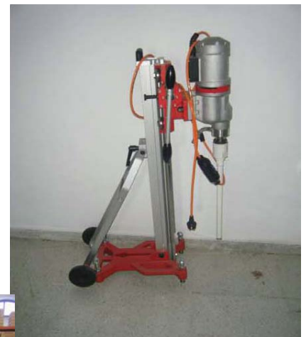
Perforadora para toma de muestras del núcleo del testigo (20mm. 24mm v 45mm).
