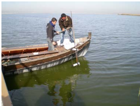
Medidas de CE/T (conductividad eléctrica/temperatura) en el lago de La Albufera (Valencia) para la localización de surgencias de aguas subterráneas. Fotografía: Bruno J. Ballesteros
