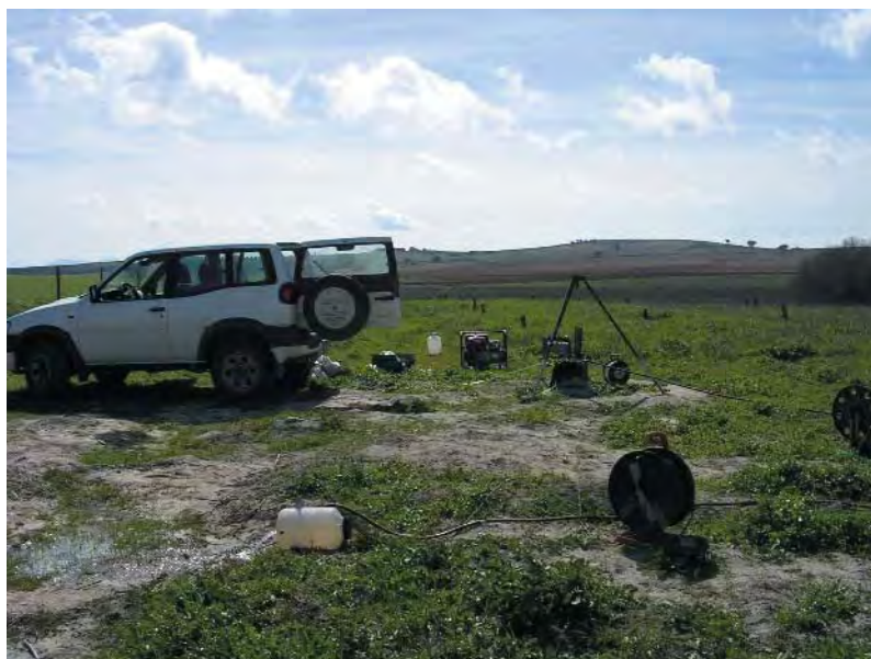
Muestreo de agua subterránea en piezómetro P.1. Laguna de Fuente de Piedra (Málaga)
