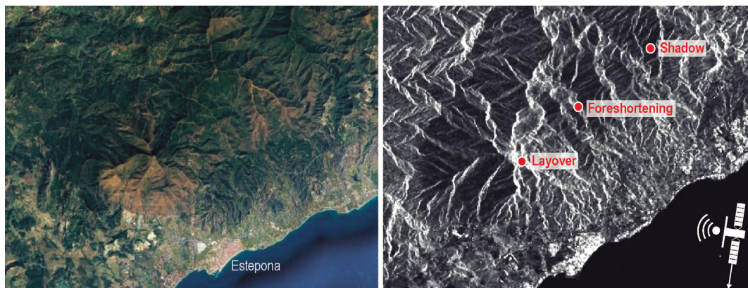
Figura 13: A la izquierda, una imagen óptica de la costa malagueña adquirida por el satélite Sentinel-2 de la ESA, en la se aprecia la zona montañosa al norte de Estepona. A la derecha, una imagen de amplitud SAR de la misma zona sin ortorrectificación , adquirida por el satélite Sentinel-1 en órbita descendente, en la que podemos observar ejemplos de las diferentes distorsiones geométricas producidas por la topografía descritas en la Figura 12.
