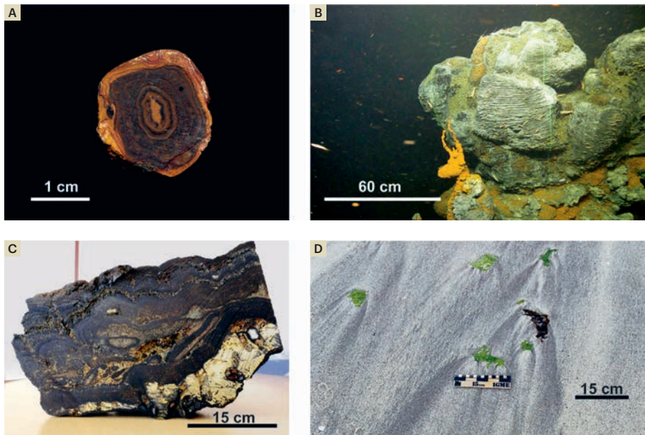
Figura 1. Ejemplos de minerales submarinos explorados por el IGME. A) Sección de nódulo de ferromanganeso del Golfo de Cádiz. B) Imagen del ROV-Luso tomada a 2800 m de profundidad que muestra chimeneas hidrotermales de sulfuros en Moytirra (dorsal mesoatlántica). C) Sección de costra de ferromanganeso rica en cobalto del Mar de Scotia (Antártida). D) Placeres de minerales pesados en las costas de las Rías Baixas (Galicia).
