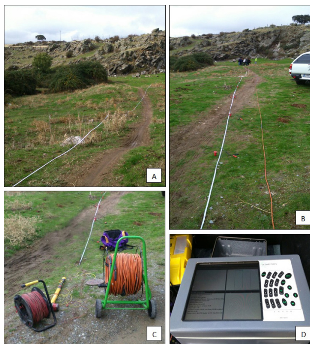
Figura 1. Desarrollo de ensayo de sismica de refracción. A) y B) perfiles y geófonos distribuidos en la zona de estudio, C) Plancha de acero, martillo percutor y cableado, D) Equipo registrador.
