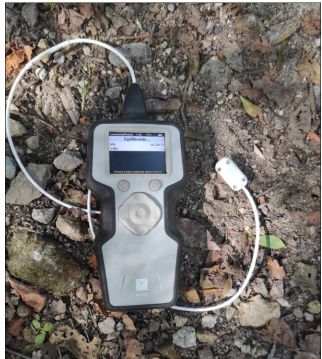
Figura 2. Equipo TEMPOS con sensor de conductividad térmica TR-3.
