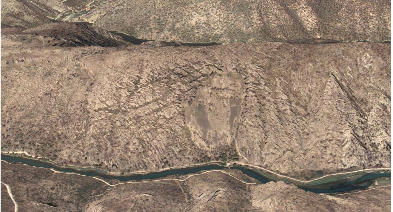
Figura o Foto 17: Zona fracturada que da lugar a la ciudad encantada y junto a ella la superficie de despegue de un deslizamiento relativamente antiguo. Elaboración propia.
