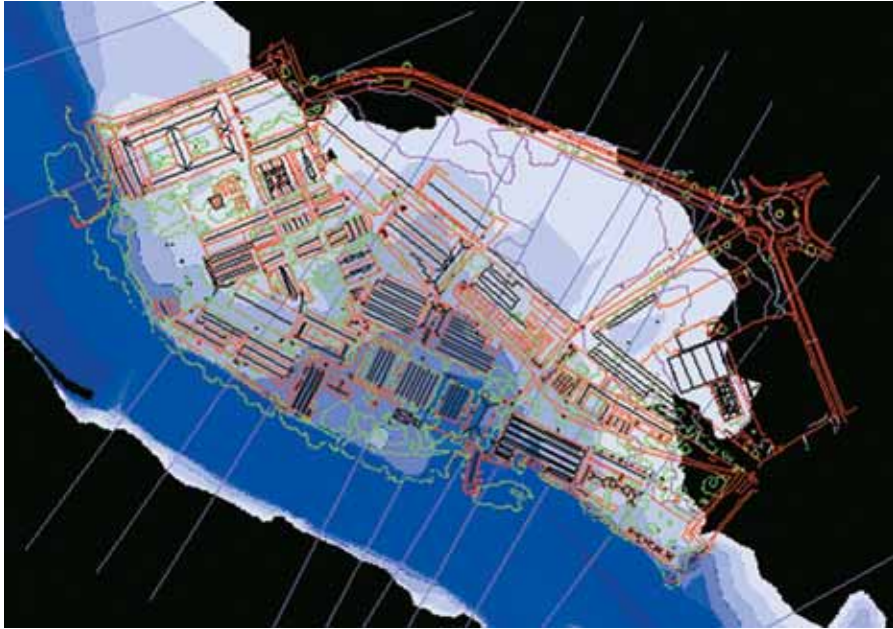
Mapa de isobatas durante la inundación de 1947 en el recinto de la antigua Fábrica de Armas de Toledo. Las líneas transversales al cauce del río Tajo corresponden con las secciones del modelo hidráulico. Equidistancia entre tonos de grises: 0,7 m (González, 2003).
