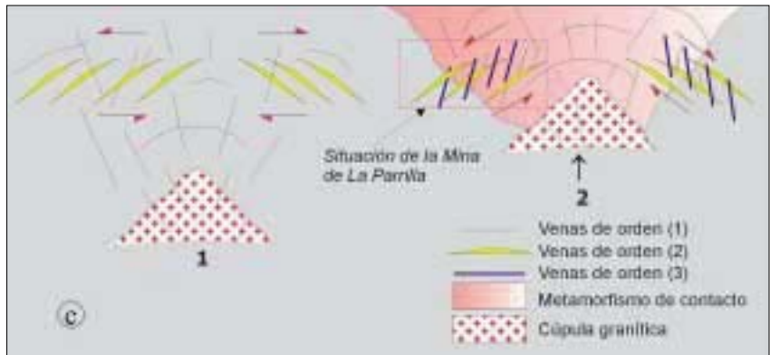
Figura 6c. Modelo de cizalla que afecta a las venas de La Parrilla, y su relación con el emplazamiento de una cúpula granítica.
