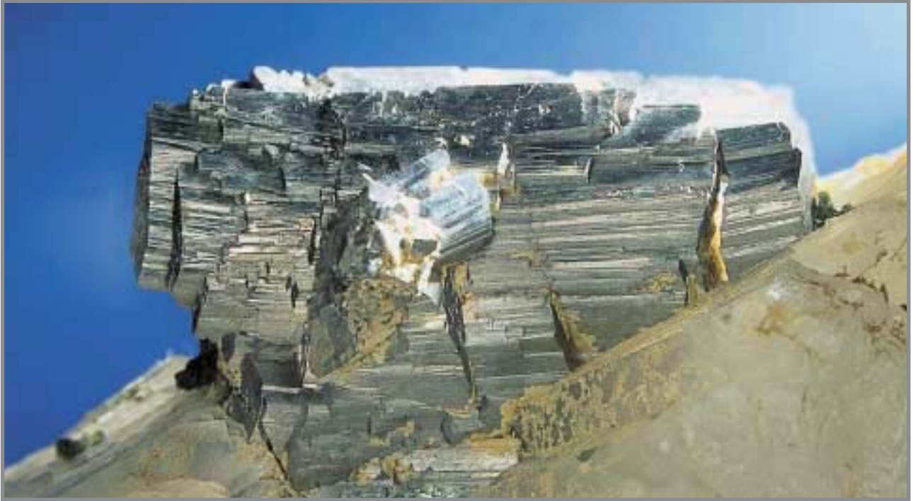
Cristal de arsenopirita de 20 mm, sobre cuarzo. Obsérvense las fracturas que ha sufrido el cristal con posterioridad a su formación. Colección y foto: F. Piña.
