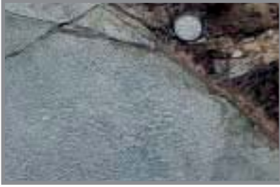
Arsenopiritización en el encajante próximo a los filones: proceso de alteración hidrotermal relacionado con la formación de los filones. Se caracteriza por la aparición de pequeños cristales de mispiquel, que van siendo más abundantes hacia los bordes de las venas. Banco 1° de la corta. Foto: P. Gumiel.
