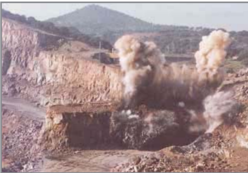
El arranque del todo-uno se realizaba mediante la perforación de barrenos de 3 pulgadas, goma 2 en fondo y nagolita como carga de columna. Normalmente cada disparo levantaba 2.000 t de material. Foto: cortesía de la Familia Bonilla.
