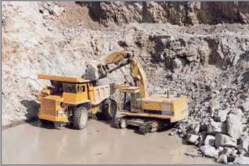
Pala de carga frontal Caterpillar 235, trabajando en el fondo de la corta Adelaida. El todo-uno arrancado se transportaba hasta la planta de trituración en volquetes de medio tonelaje. Año 1985. Foto: cortesía de la Familia Bonilla.
