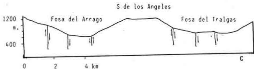
Fig. 4. Valles altos del Arrago y Tralgas. A) Fallas principales e inclinación de los bloques. B) Corte transversal de la fosa del Arrago. C) Corte transversal de las fosas del Arrago y Tralgas y del horst la Sierra de los Angeles.
