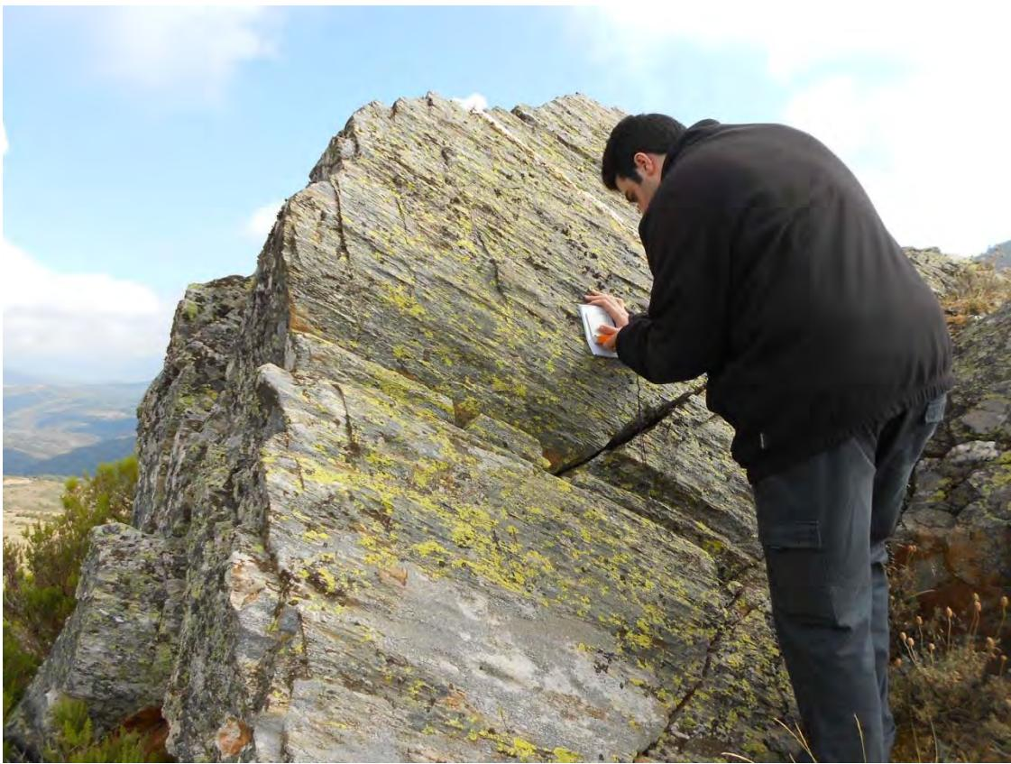
**Figura o Foto 23:** Plano de falla de lado derecho ( $230^{\circ}/65^{\circ}$ , estrías  $30^{\circ}\text{S}$ ), en cuarcitas.
