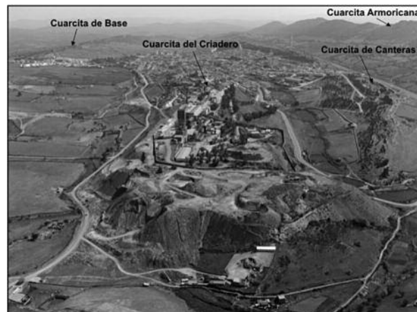
Figura 3. Trazo de las unidades de cuarcitas en el flanco meridional del Sinclinal de Almadén.
