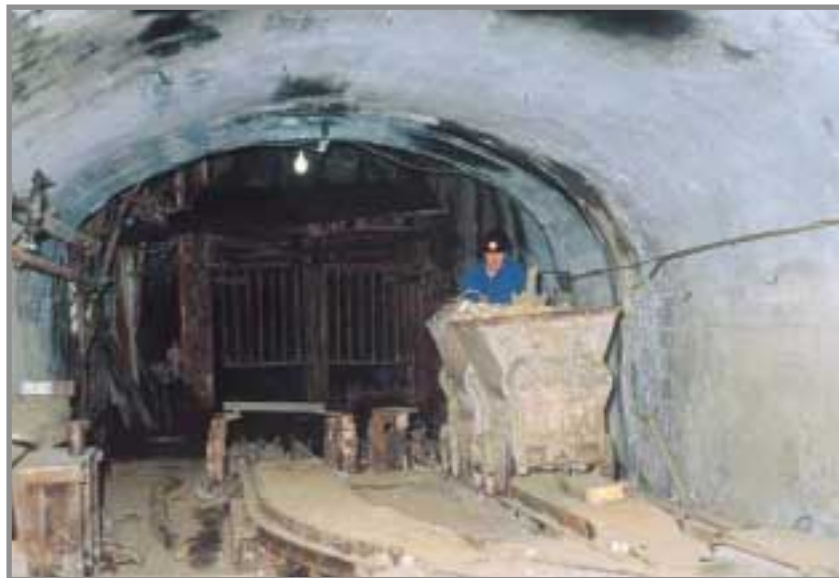
FOTO 28.- Planta 19ª de la Mina de Almadén. Embarque semi-automático de vagonetas en la cortadura de planta 19ª del Pozo San Teodoro.
