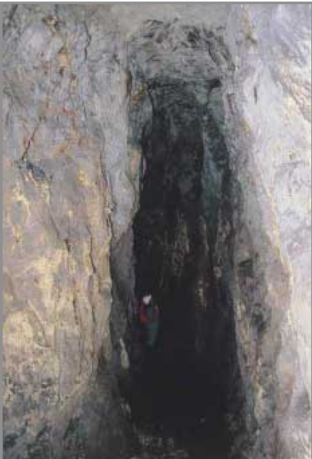
FOTO 1.- Mina del Pozo, Planta 1ª de la Mina de Almadén. Explotación en testero del siglo XVIII de un banco mineralizado.
