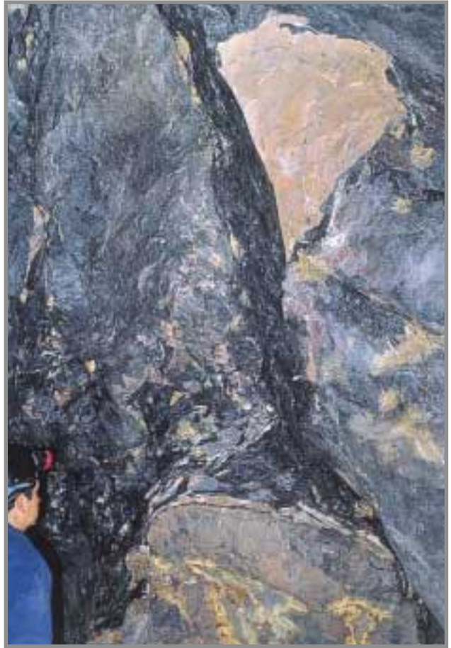
FOTO 21.- Planta 14ª de la Mina de Almadén, Rama Sur. Falla transversal poniendo en contacto brechas heterogéneas con rocas subvolcánicas de tipo diabasa. Esta falla se sigue por toda la mina y es la que separa la Rama Sur del resto de zonas del yacimiento.
