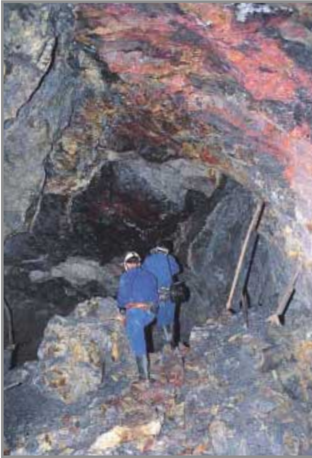
FOTO 19.- Galería de base del Macizo de Poniente de la Mina de Almadén, Rama Sur. Parte basal de la cámara diseñada para la explotación del Macizo de Poniente con minerales de alta ley.
