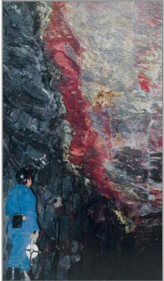
FOTO 26.- Planta 15ª de la Mina de Almadén, Zona de Los Masivos. Mineralización de alta ley del Banco de San Pedro. El tramo pizarroso de la izquierda de la foto corresponde a las Pizarras Intermedias.
