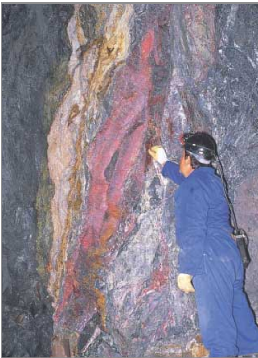
FOTO 17.- Planta 12ª de la Mina de Almadén, Rama Sur. Falla longitudinal cortando y deformando al 3º macizo. En la imagen, esta gran estructura de cizalla, que es denominada "Falla G", pone en contacto las cuarcitas mineralizadas con brechas heterogéneas con mucha matriz pizarrosa.
