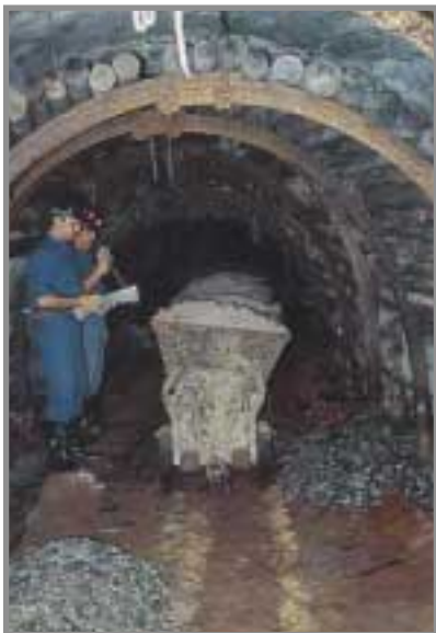
FOTO 27.- Planta 17ª de la Mina de Almadén. Vagonetas cargadas con escorias procedentes de la planta metalúrgica, utilizadas para el relleno en los tajos realizados por corte y relleno. Las vagonetas están situadas en una galería transversal que daba acceso a uno de los coladeros por donde se introducían los rellenos a la explotación.
