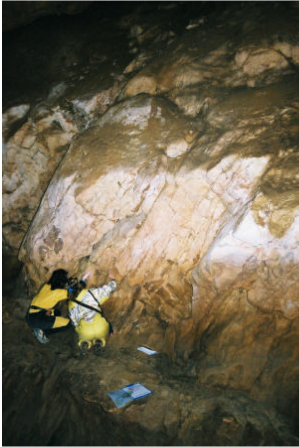
Foto 61 Aspecto de la pared izquierda del tramo (sector 17.4.) y discontinuidades 208/50 (estratificación) y 50/27 (diaclasas)
