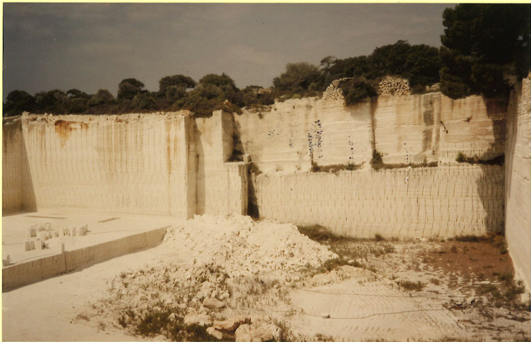
20. Cantera de Alcaufar. Explotación de "marés". (Taludes arrecifales de la Unidad Superior del Mioceno).
