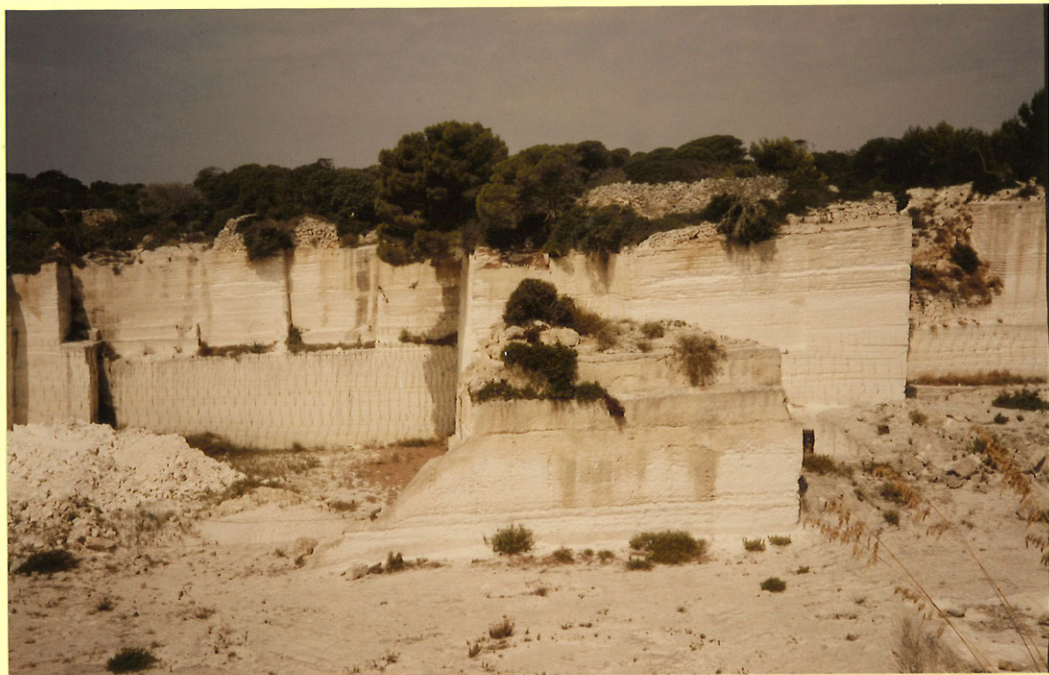
19. Cantera de Alcaufar. Explotación de "marés". (Taludes arrecifales de la Unidad Superior del Mioceno).
