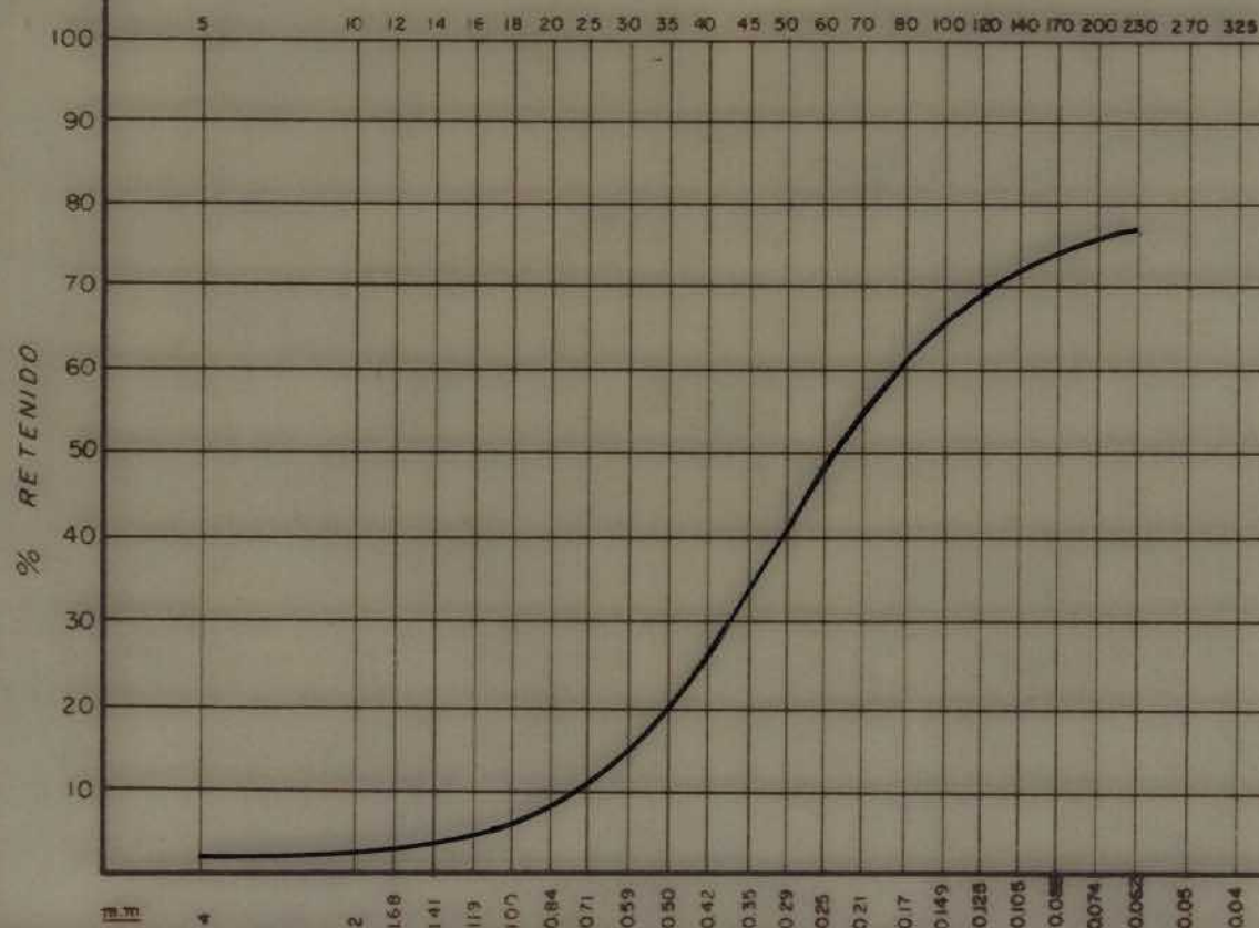
CURVA GRANULOMETRICA ACUMULATIVA TAMICES A STM
