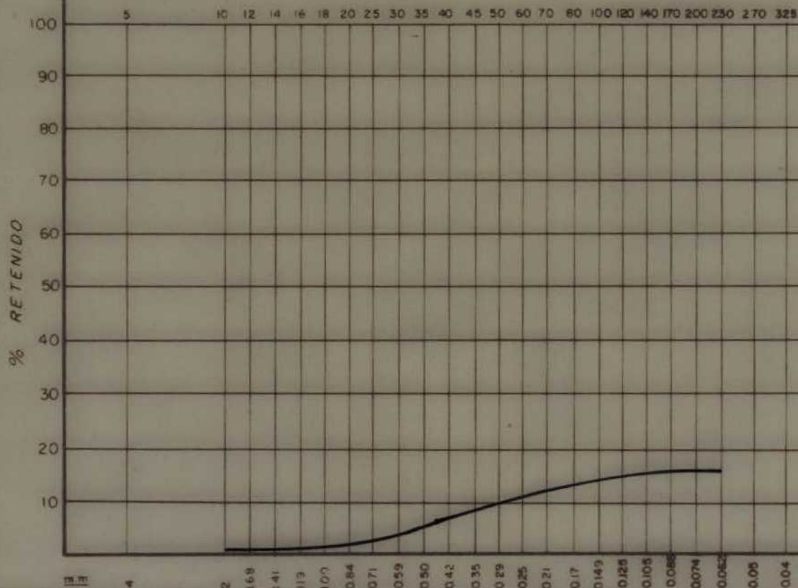
CURVA GRANULOMETRICA ACUMULATIVA TAMICES A STM
