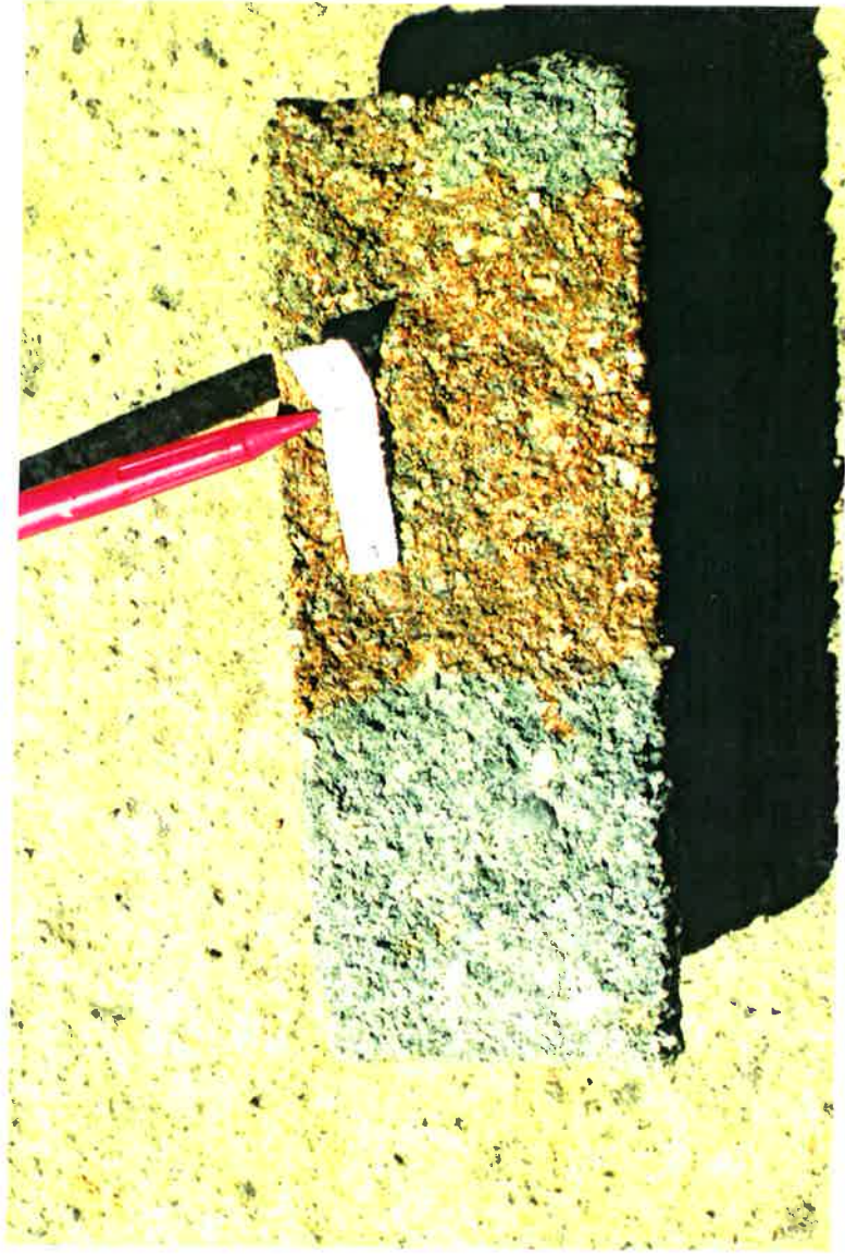
JN 9251 Arcosas. Muestra del Sondeo nº 72, metro 177 (Proyecto 0116 JEN). Obsérvese el aspecto masivo, la heterometría y el color grisáceo que suelen presentar estas facies; asimismo puede apreciarse (color rojo) que han sido afectadas por procesos de hidromorfismo.
