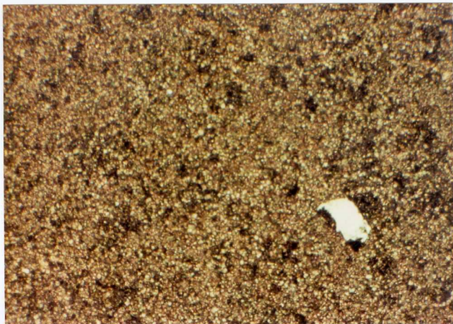
F.33.- Dolomía microcristalina (sacaroidea) con algún detrítico disperso. Muestra 4011. Unidad 6 del Mioceno. Urbanización Pablo Iglesias 2ª fase. Norte del Cerro del Telegrafo. N X x 10.
