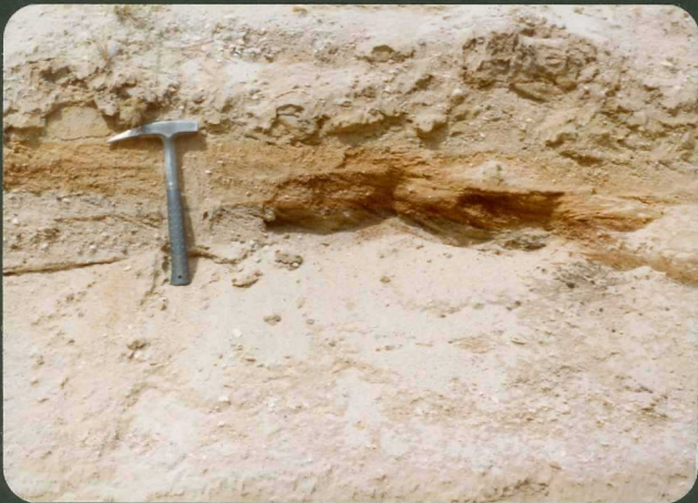
FOTO 17.- Arcosas microconglomeráticas con estratificación cruzada en surco FC 9017
